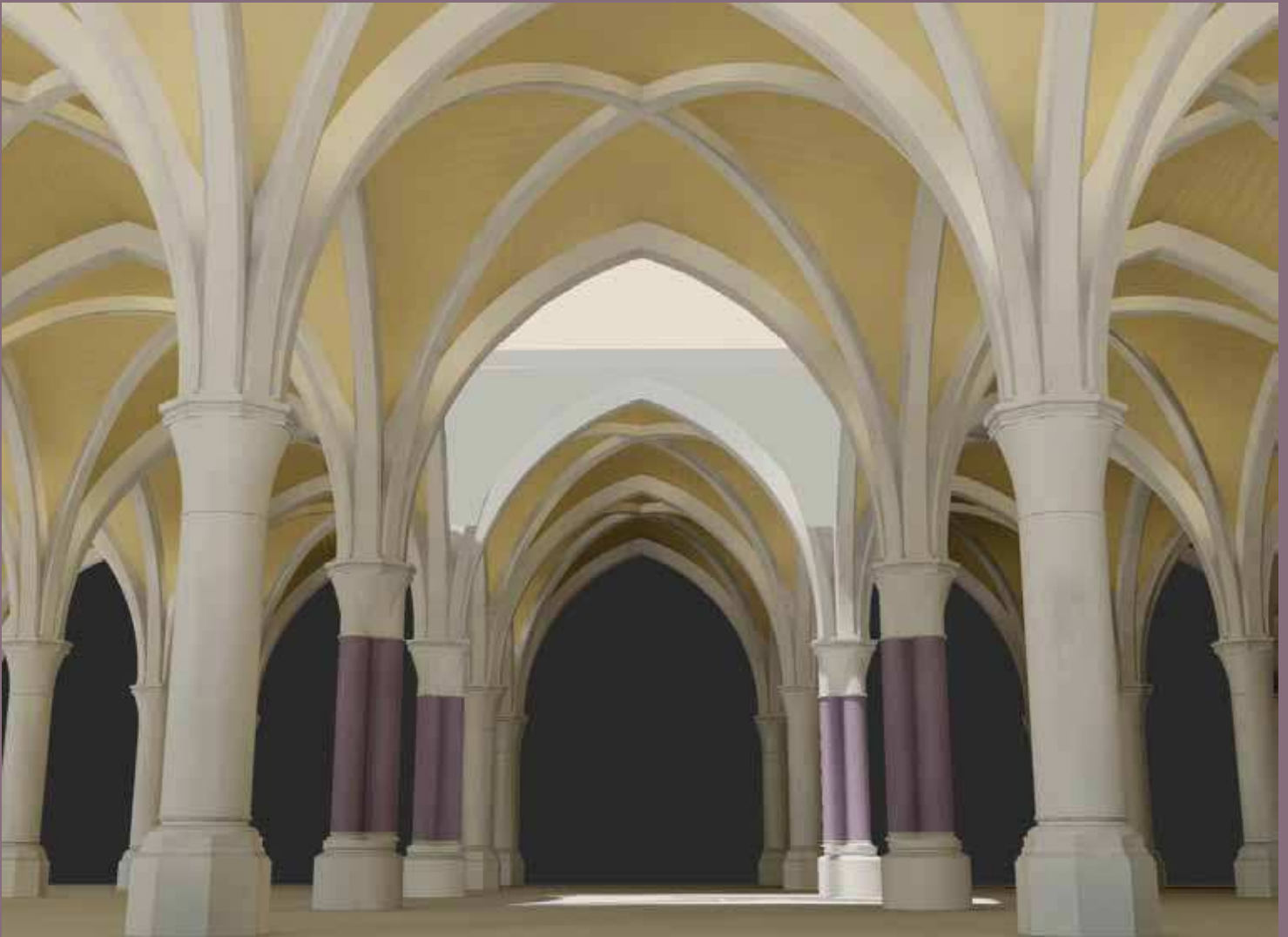
Ipotesi di ricostruzione tridimensionale della sala colonnare del castello Maniace a Siracusa, con la variante della campata.
